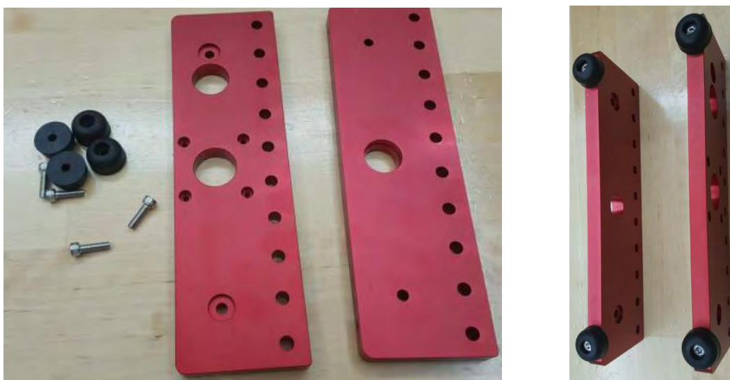
Figura 36.- Montaje de placa de plataforma
