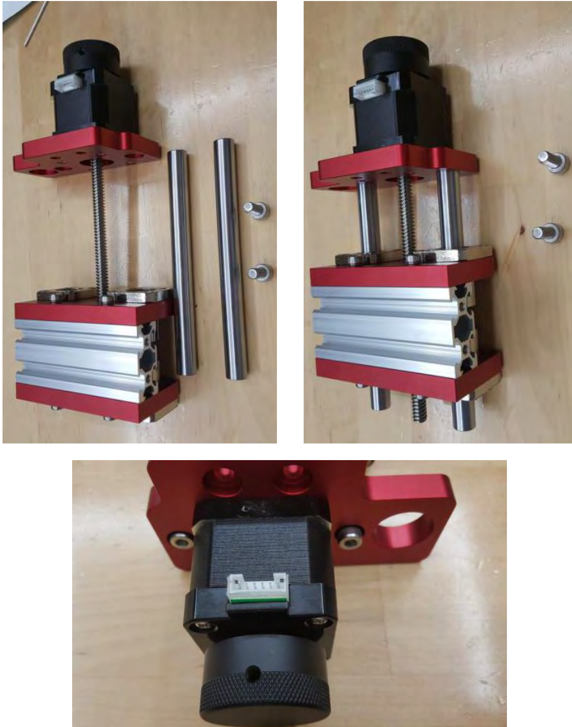
Figura 27.- Ensamble de varillas en base de motor
