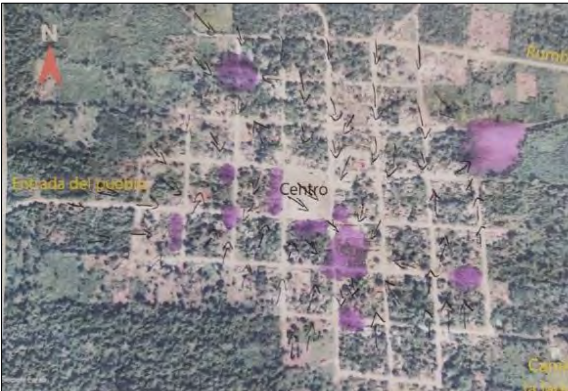
Figura. 26 Imagen aérea de la comunidad con zonas de inundación y dirección de esorrentía de acuerdo con la percepción de habitantes. Fuente: elaborado durante trabajo de campo, 2021.
