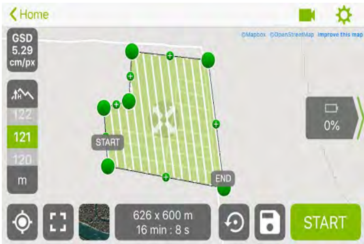
Figura 2. Plan de vuelo de la aplicación Pix4D-Capture
