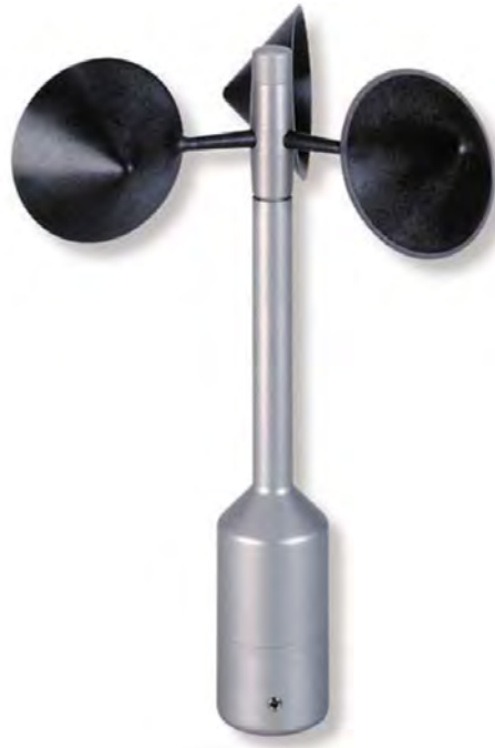
Figura 2.13: Anemómetro de copa (tomado de [44]).
