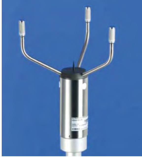
Figura 2.16: Anemómetro ultrasónico (tomado de [44])
