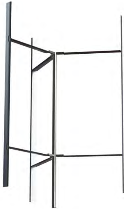
Figura 4.28: Rotor de VAWT diseñado en SolidWorks.
